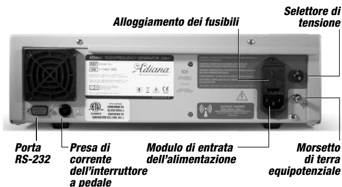
FIGURA 2: PANNELLO POSTERIORE DEL GENERATORE RF
