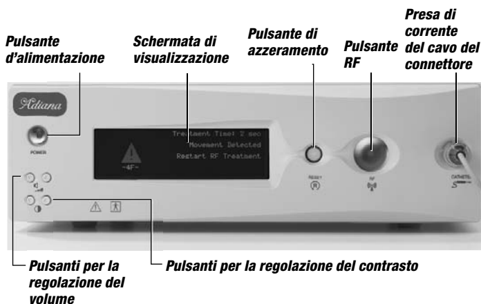
FIGURA 1: PANNELLO ANTERIORE DEL GENERATORE RF
